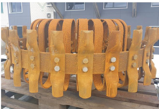
Mit Säure eingesprüht und dem Wetter ausgesetzt.
